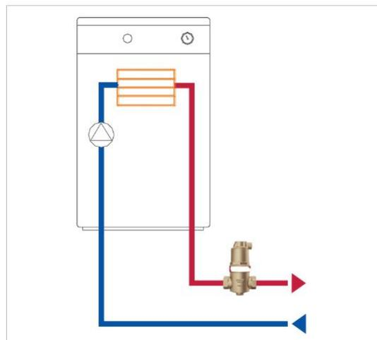
Il senso del fluido è indifferente nel caso di disaeratore con attacchi lineare (art.520), mentre deve seguire il senso della freccia stampata sul corpo dello stesso nel caso di disaeratore con attacchi girevoli (art.521).
